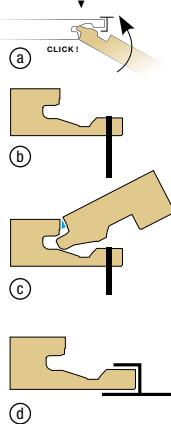
④ ⑤ De lange zijden van de panelen beschikken over een gepatenteerd kliksysteem. De panelen worden bevestigd met nietjes, met onze Plano-clips 1513 of met een montagelijm.
